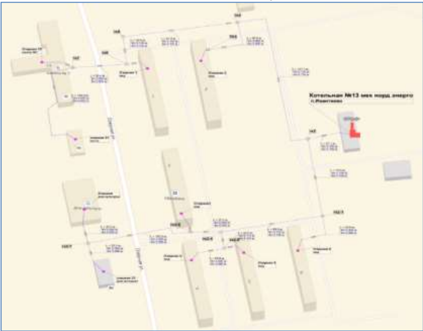
Рисунок 1. Схема тепловых сетей котельной № 13, п. Ивантеево
