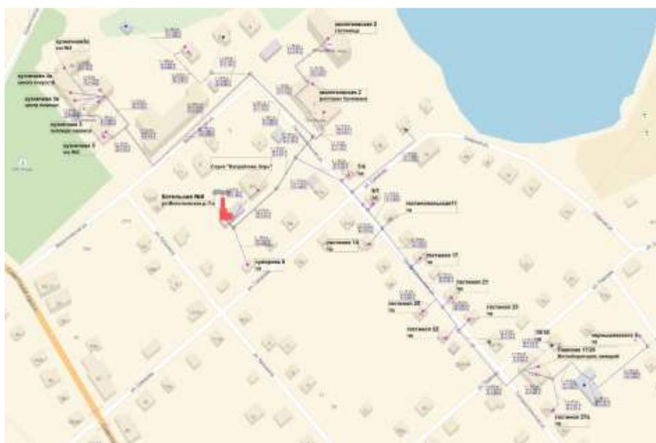
**Рисунок 6.** Схема тепловых сетей № 8 г. Валдай, ул. Молотковская, д.11а
