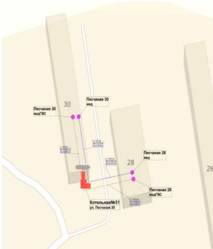
Рисунок 15. Схема тепловых сетей котельной №31 г. Валдай, ул. Песчаная, д. 30
