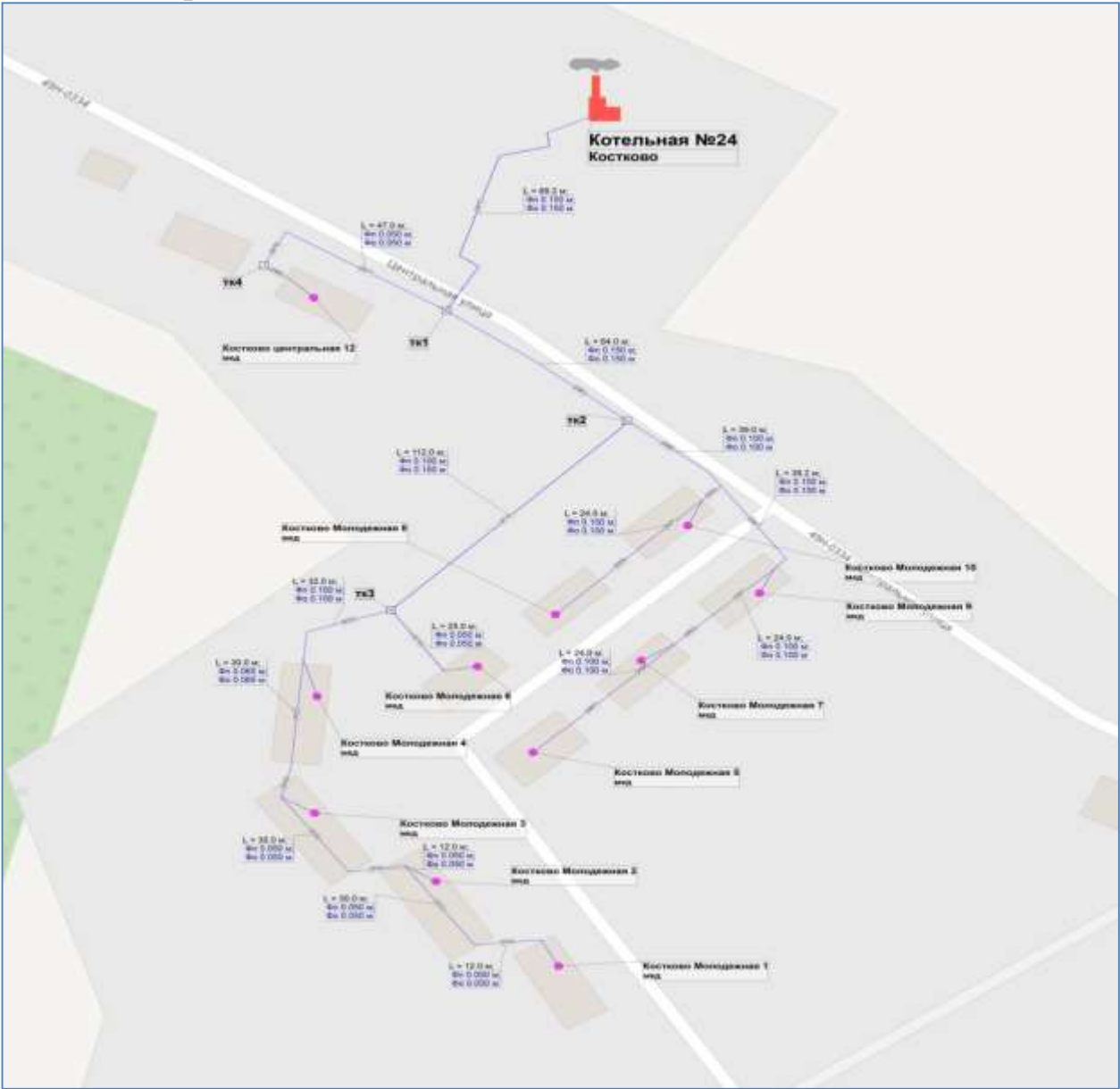
Рисунок 1. Схема тепловых сетей котельной № 24, д. Костково
