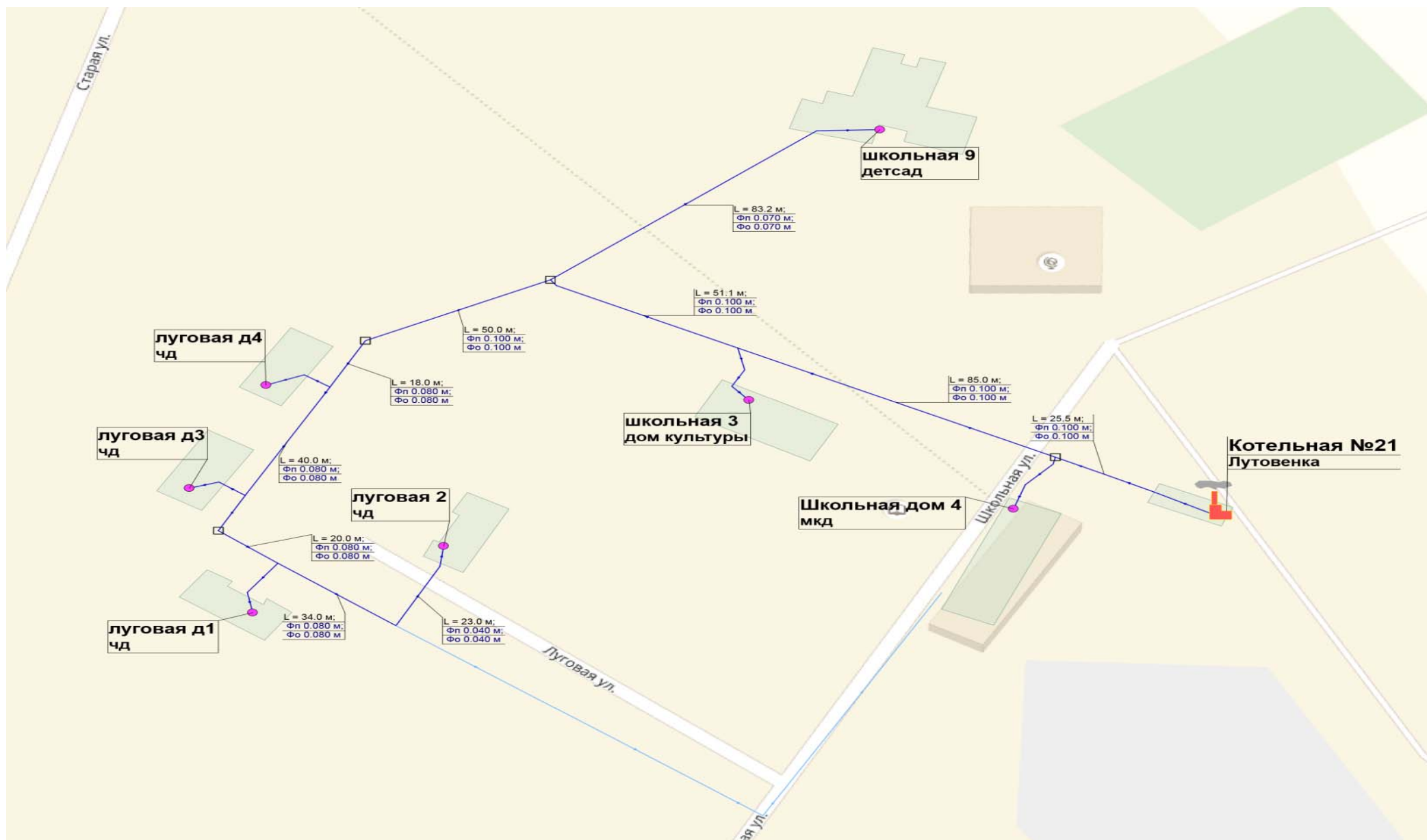
Рисунок 1. Схема тепловых сетей котельной № 21 д. Лутовенка.
