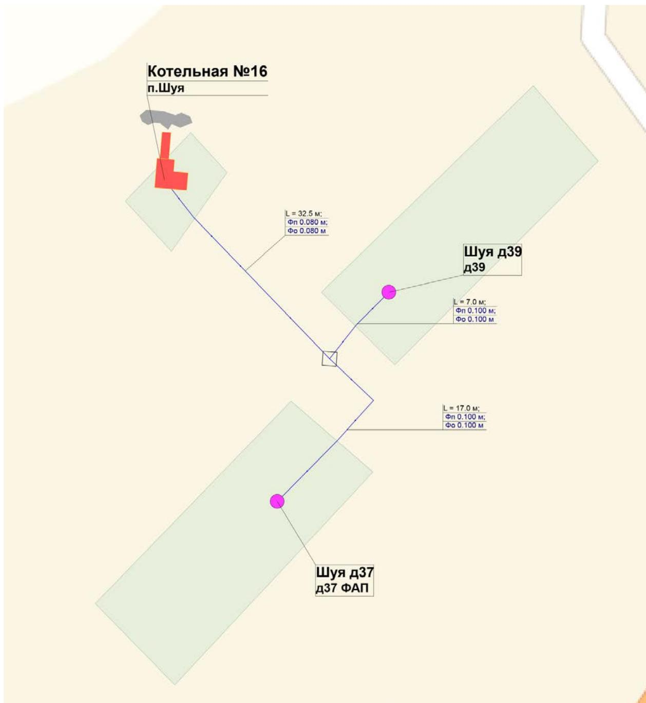
Рисунок 2. Схема тепловых сетей котельной №16 д. Шуя
