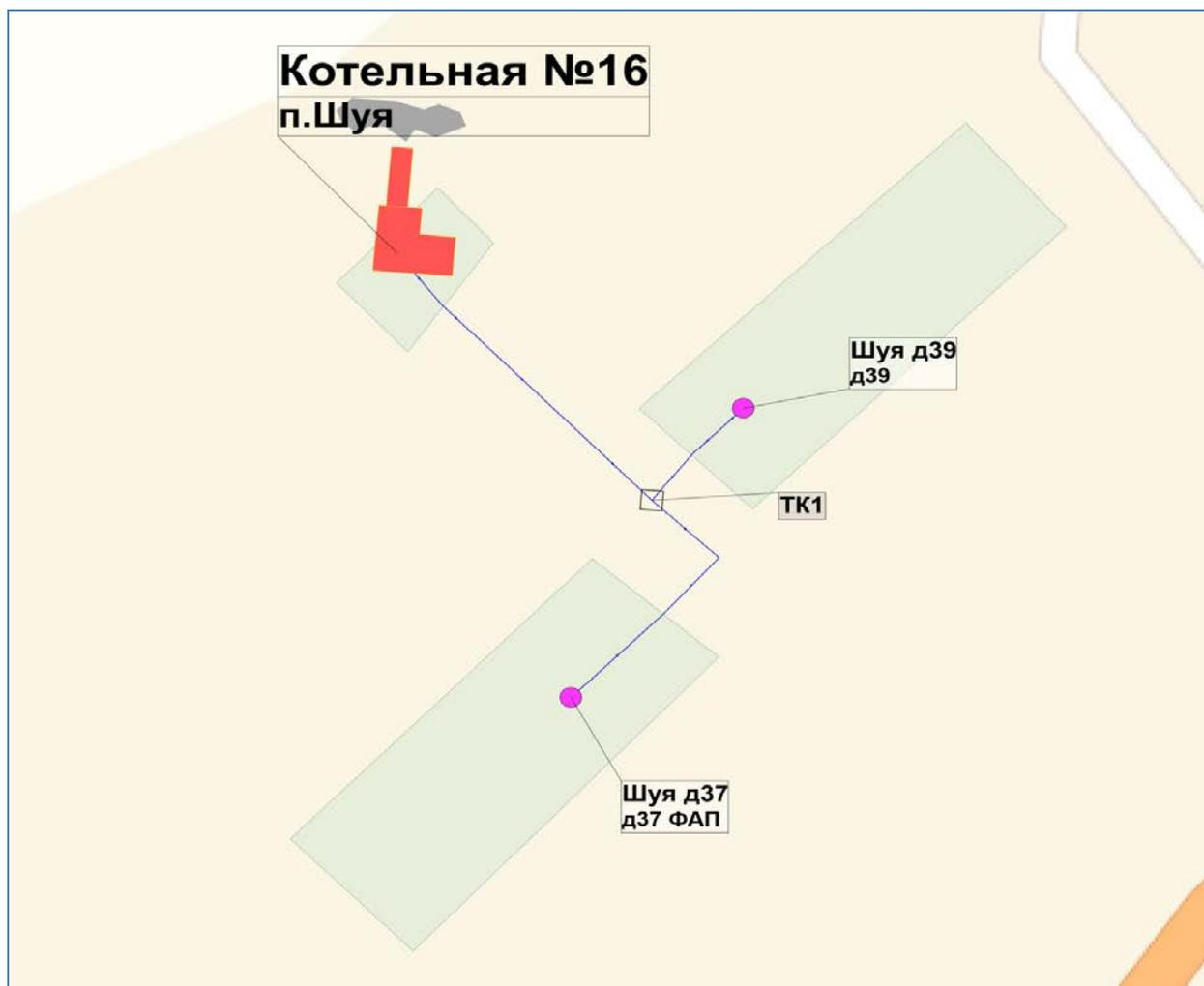
Рисунок 1. Схема тепловых сетей котельной № 16, д. Шуя
